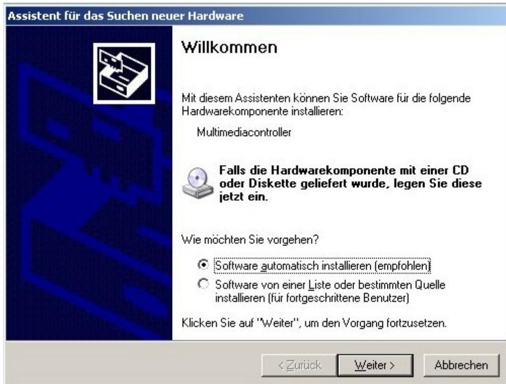
Die automatische Erkennung identifiziert nunmehr die neue Karte und installiert sie als Multimedia-Controller.
